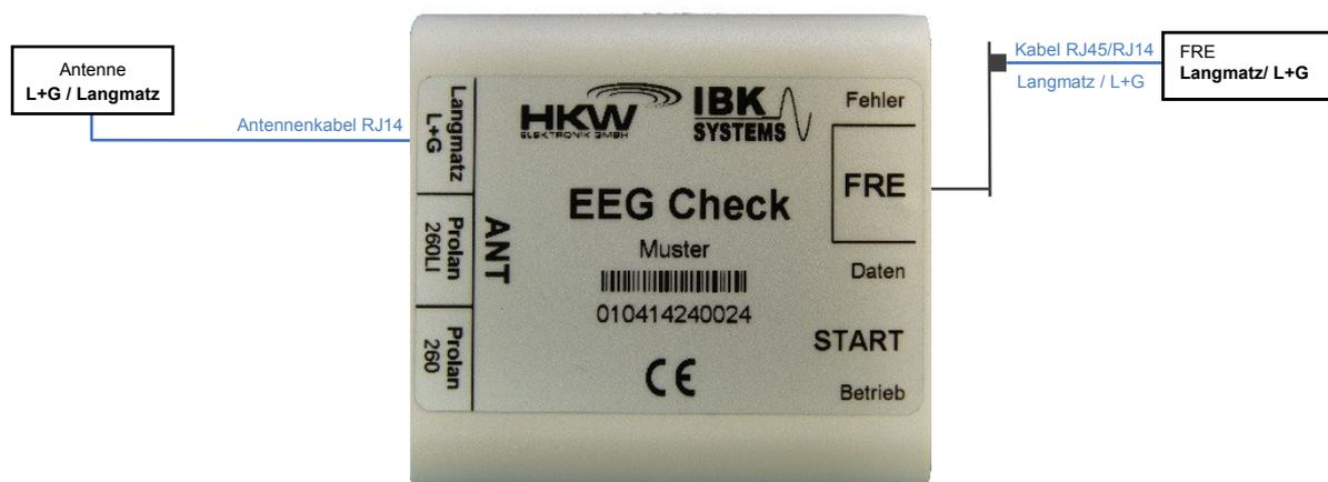
Hinweis: Die Position der Antenne darf nach Testdurchführung nicht mehr verändert werden, da die Empfangseigenschaften von der Position und Ausrichtung der abgesetzten Antenne abhängen.
