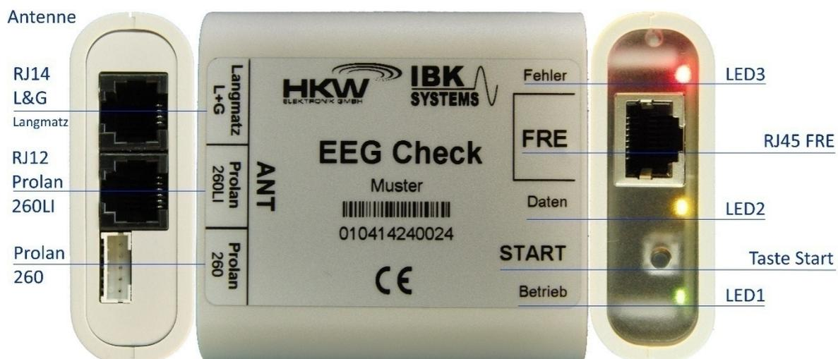
Zum Lieferumfang gehört ein Anschlusskabel L+G passend für die Verbindung zwischen Empfänger (FRE) und Testwandler.
