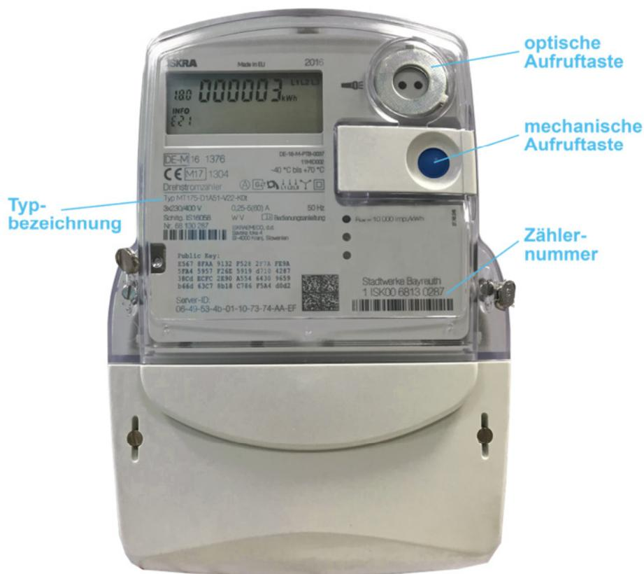
Die optische Taste ist ein lichtempfindlicher Sensor, der nicht auf Berührung, sondern auf den fokussierten Lichtstrahl einer handelsüblichen Taschenlampe reagiert. Damit oder mit der mechanischen Taste wird die untere Zeile des Displays bedient.
